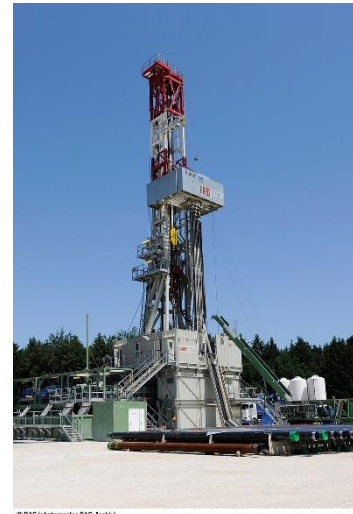
Afbeelding 6: Tijdelijke boorinstallatie diepboring (bron: RED Drilling & Services)
